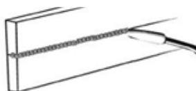
Рисунок 22. Сварка в горизонтальном положении
