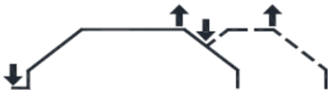
Рисунок 4. 2х тактный режим работы горелки
