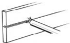
Рисунок 19. Горизонтальное положение при сварке
