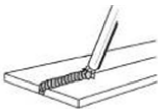
Рисунок 18. Нижнее положение при сварке
