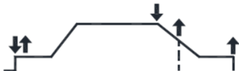
Рисунок 5. 4х тактный режим работы горелки
