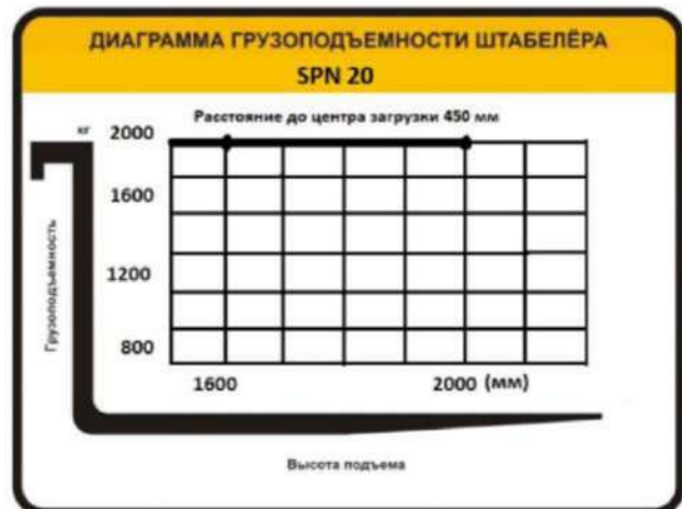
Рисунок. 4. Диаграмма грузоподъемности штабелера.
