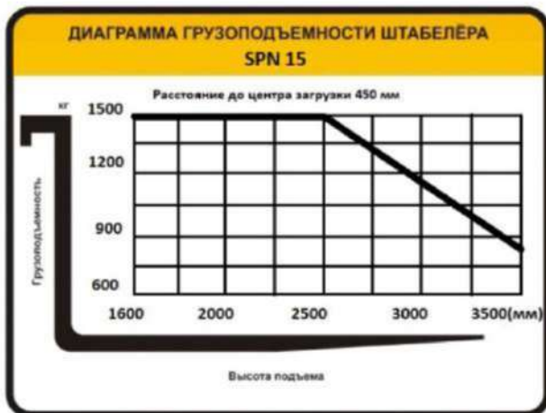
Рисунок. 4. Диаграмма грузоподъемности штабелера.
