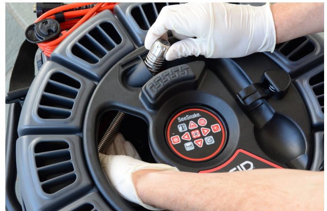
Рисунок 4 – Укладка головки камеры
