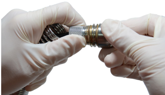
Рисунок 23 – Демонтаж головки камеры
