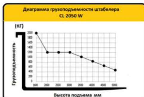
Рисунок 5. Диаграмма грузоподъемности штабелера.
