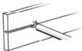
Рисунок 13. Горизонтальное положение при сварке
