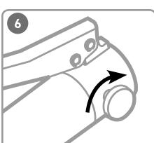
Поверните винт сброса давления в положение «Закрыто» и прокачайте помпу.
