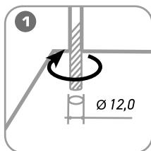
Просверлите в листе направляющее отверстие Ø 12 мм, совпадающее с центром пробиваемого.
