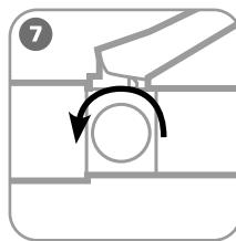
Для сброса давления поверните винт сброса давления помпы в положение «Открыть»
