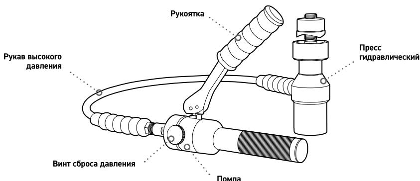
Гидравлические системы для перфорации отверстий **ПГПО-60, ПГПО-60А, ПГПО-115** состоят из гидравлического пресса и гидравлической помпы соединенных между собой рукавом высокого давления.
