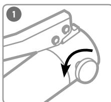
Поверните винт сброса давления в положение «Открыто»
