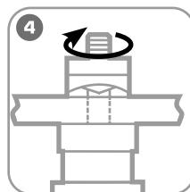
Вставьте шпильку в направляющее отверстие, а пuhanсон на шпильку до упора в лист.
