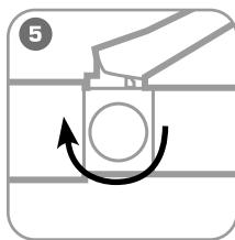
Поверните винт сброса давления помпы в положение «Закрыть»
