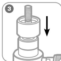
Поверх опорной втулки установите выбранную матрицу 16,2; 18,6; 20,5; 22,5; 25,4 мм.
