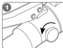
Поверните винт сброса давления в положение «Открыто»
