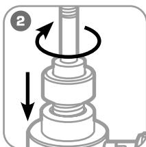
Закрните шпильку Ø 11/20 мм в шток. На шпильку установите выбранную опорную втулку.
