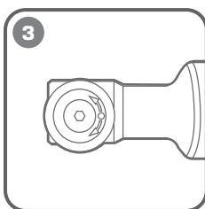
**Зафиксируйте штифт преодолевая усилие пружины до упора его головки в рабочую голову, затем поверните его вокруг оси так, что бы метка на его головке была расположена в сторону корпуса инструмента**
