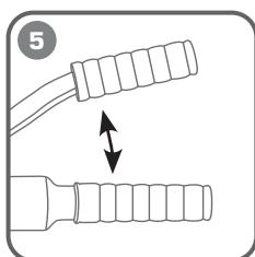
**Работая подвижной рукояткой опрессуйте изделие. В конце цикла опрессовки сработает клапан автоматического сброса давления (АСД) и шток поршня вернётся в исходное положение**
