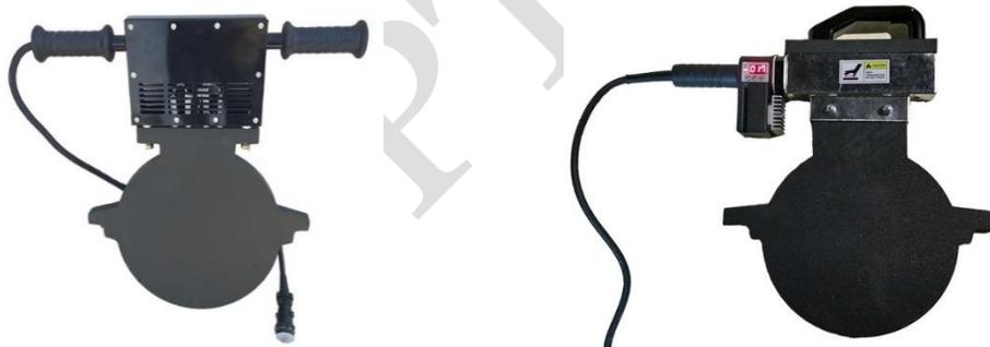
Электронагреватель (нагреватель, паяльник, утюг, зеркало, блин, сковорода и т. д.) предназначен для нагрева концов (торцов) полимерных труб в процессе сварки. Бывают автономные с блоком управления на самом корпусе нагревателя и подключаемые к блоку питания и управления. Автономные имеют плюс в том, что могут работать от сети, но большой минус в том, что от высокой температуры очень часто выходят из строя.
