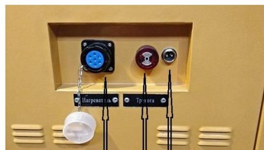
Разъем нагревателя      Сигнальная лампа      Разъем протоколера
