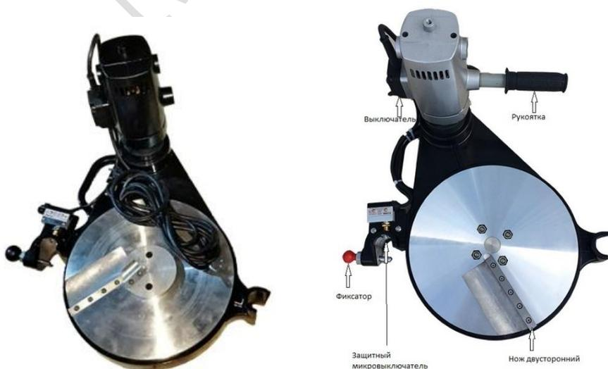
Торцеватель переназначен для выравнивания торцов труб перед сварочным процессом. Устанавливается на штанги центратора между двух зажатых в хомутах труб. Включается. Трубы плавно сводятся, прижимаются к торцевателю с двух сторон. Ножи, установленные на вращающихся дисках снимают стружку. После выхода непрерывной стружки длиной в 2-3 оборота, торцевание можно закончить.
