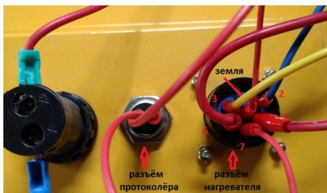
1 контакт земля, 2 синий и 3 желтый приходят от термопары нагревателя и уходят на терморегулятор, 5 и 6 толстые красные силовые через контакты контактора на автомат ввода 220 в., 4 и 7 тонкие красные от термопары на разъём протоколера слева.
