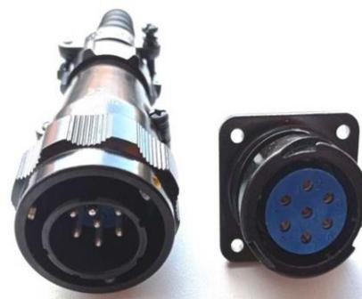
Электроразъём нагревателя. Совместить контакты с одинаковыми номерами, повернуть слегка против часовой стрелки, слегка нажать и повернуть по часовой. Шайбы войдут в пазы и механизм защелкнется.
