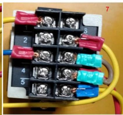
1-желтый, 3-синий через 3 и 2 контакты разъёма передают сигнал от термопары, по достижении заданной температуры, терморегулятор через желтый провод 7 замыкает цепь управления контактора 1810, контакты замыкаются и питание подается на нагреватель.
