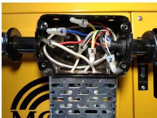
Цифрами указаны номера контактов на разъёме. Толстые провода (красный и синий) 5 и 6 силовые, подключены к выходам ТЭНа. Две пары тонких (красно-белых) это два контура термопары, два провода идут на терморегулятор и два других на разъём протоколера.
